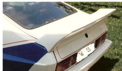
**Turbo Heckflügel aus GFK WST 101T****( ist 4 teilig , muss zusammen geklebt werden )**
