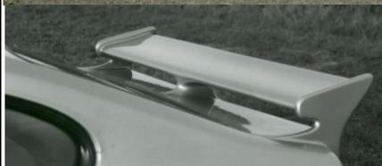
**Heckklappe mit WS Heckflügel**
