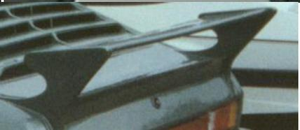
**Heckklappe mit WS Flügel**
